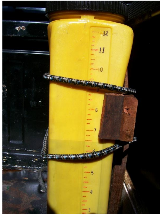
Figura 4.1.4: Reservatório ad hoc semi-transparente com graduação a cada 250ml. Fonte: Acervo do autor, 2014.
