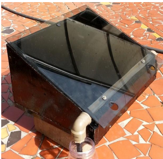
Figura 3.1.6: Destilador de água solar. Fonte: Acervo do autor, 2014.
